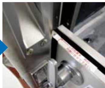
回転式ハンドルで1段目のパネルを固定
