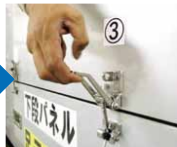
アタッチメントで1段目と2段目を締め付け固定
